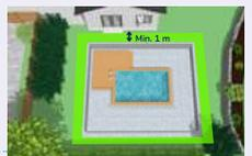
Aucune fenêtre d'un bâtiment ne doit être située à l'intérieur de cette bande de 1 m, sauf si cette fenêtre :
